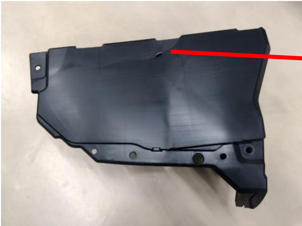
導入前 ガス溜り部、穴が空く不具合発生
