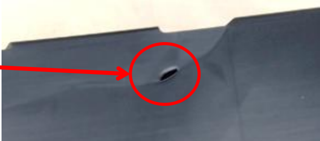
導入前 ガス溜り部、穴が空く不具合発生
